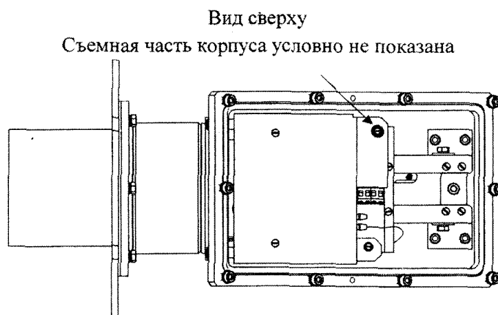
Стрелкой указано место пломбировки от несанкционированного доступа Рисунок 5 – Схема пломбировки МОК измерителя ИКВЧ-М-Н от несанкционированного доступа
