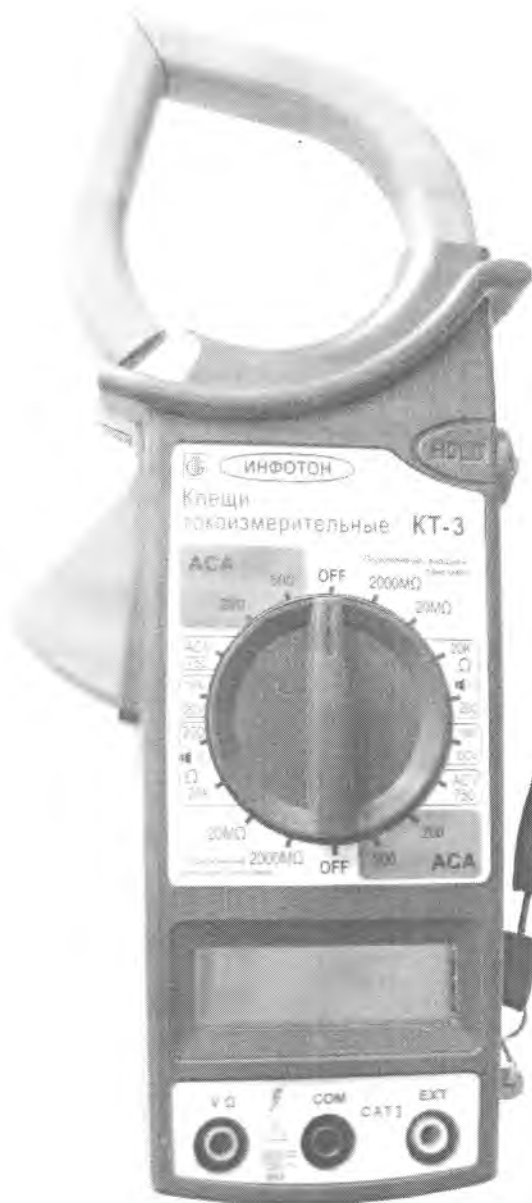
Рисунок 1 – Клещи токоизмерительные КТ-3. Внешний вид
