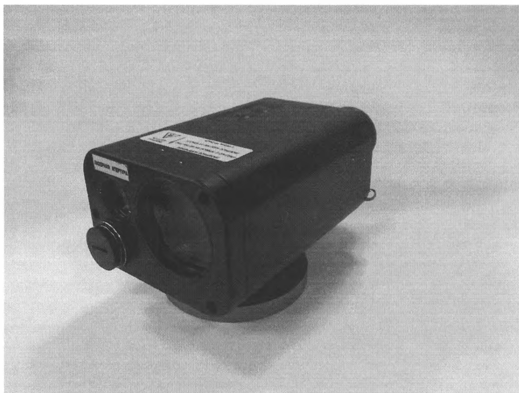
Рисунок 1 – Общий вид дальномера ДЛ-2
