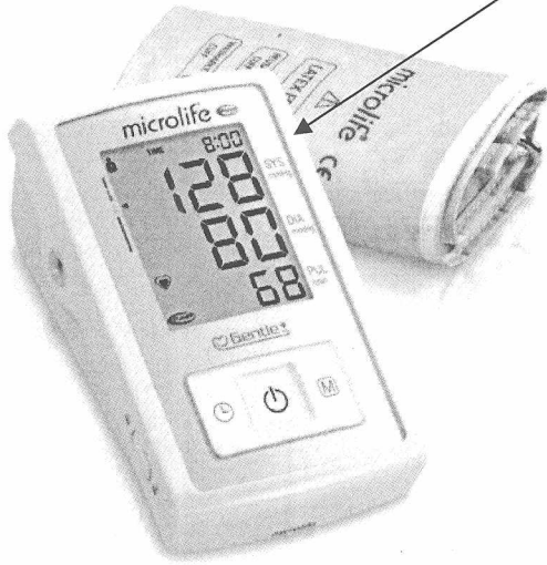
Рисунок А.1 Внешний вид измерителя BPA2 Basic и место нанесения знака поверки
