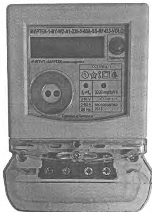
Рисунок 3 – Внешний вид счетчика в корпусе модификации W2
