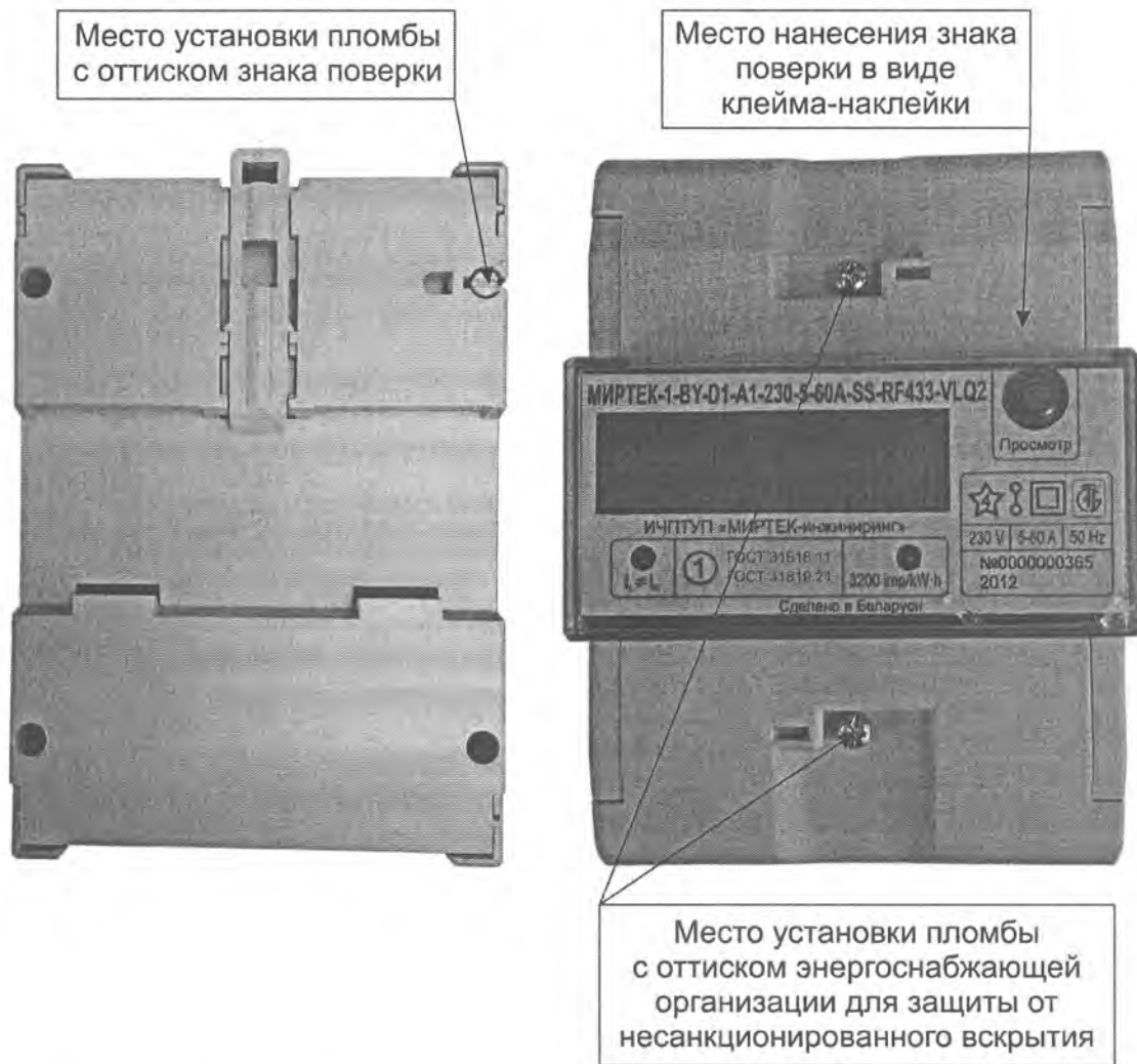
Рисунок А.3 – Места установки пломб и нанесения знака поверки для счетчиков в корпусе модификации D1
