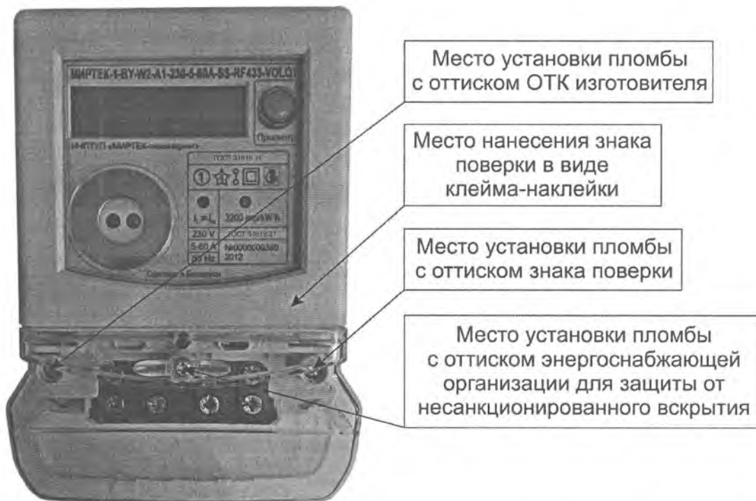
Рисунок А.2 – Места установки пломб и нанесения знака поверки для счетчиков в корпусе модификации W2
