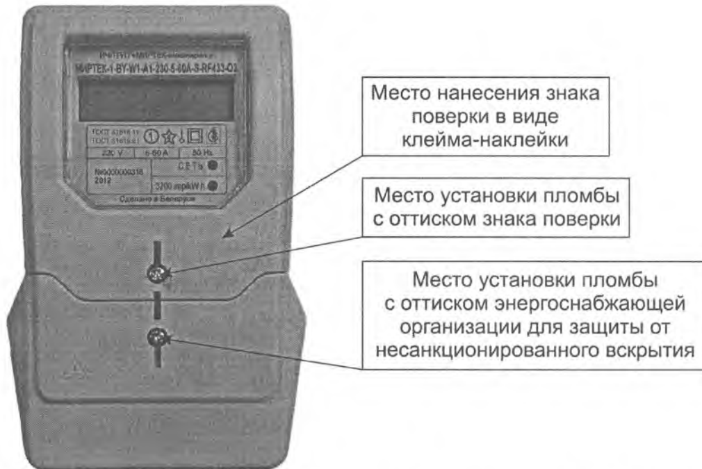
Рисунок А.1 – Места установки пломб и нанесения знака поверки для счетчиков в корпусе модификации W1
