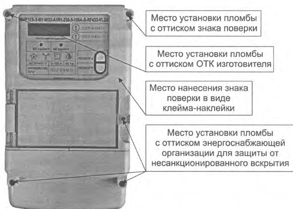
Рисунок А.2—Места установки пломб и нанесения знака поверки для счетчиков в корпусе модификации W32
