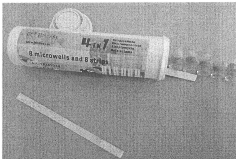
Рисунок 2 – Внешний вид наборов для экспресс-анализа DK Bioeasy 2in1milk и DK Bioeasy 4in1milk
