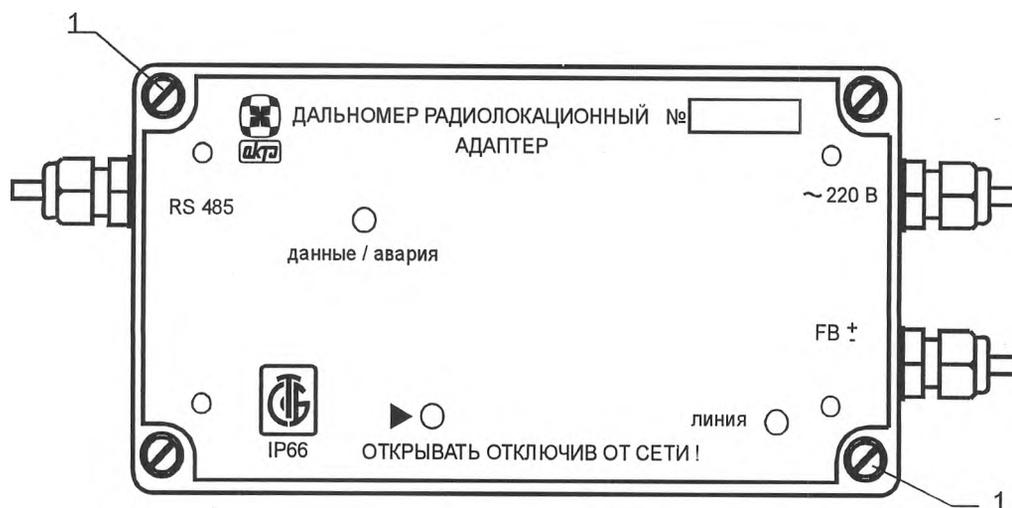
Рисунок 2 Пломбирование адаптера .
