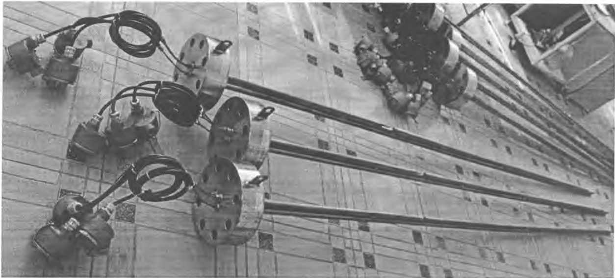
Рисунок 1 – Внешний вид преобразователей термоэлектрических многозонных T-BAR
