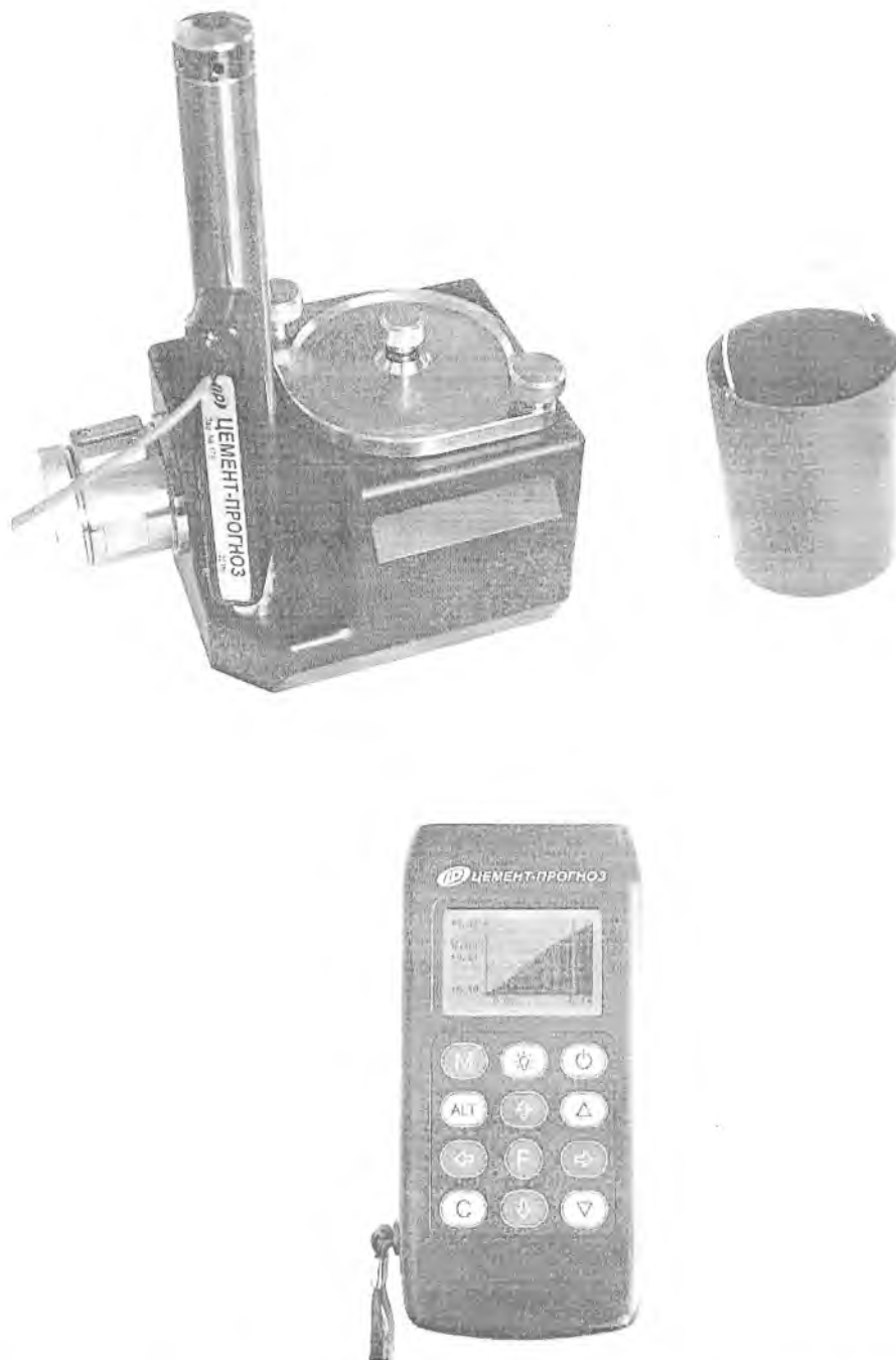
Рисунок 2 – Общий вид измерителя контракции (объемных деформаций) цемента ЦЕМЕНТ-ПРОГНОЗ (модификация ЦЕМЕНТ-ПРОГНОЗ-2)
