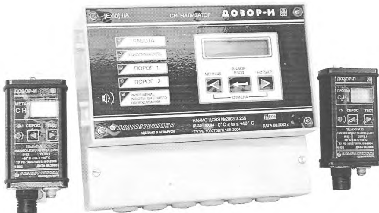
Внешний вид сигнализатора исполнения «ДОЗОР-И» (в качестве датчиков показаны исполнения «ДОЗОР-М», «ДОЗОР-П»)
