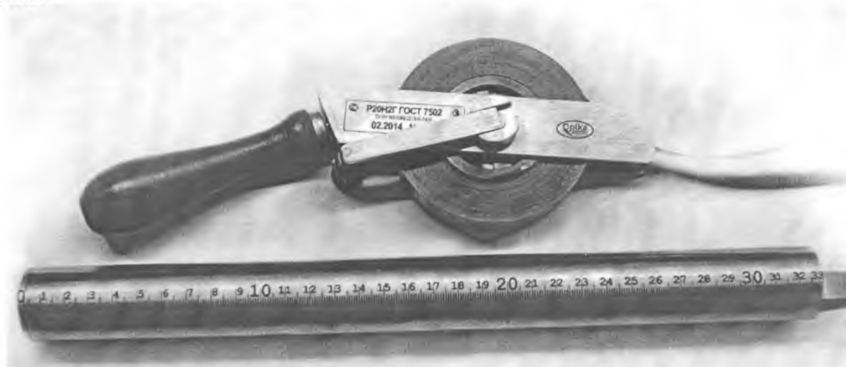
Рисунок 1 Внешний вид рулеток класса ГОСТ 7502
