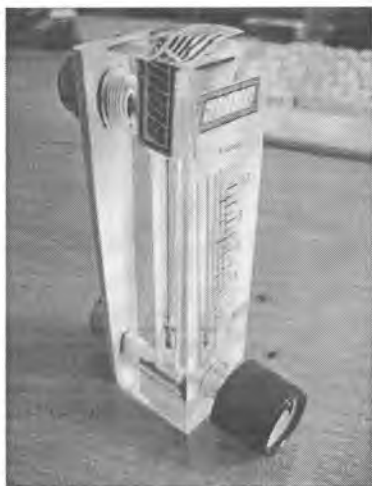
Рисунок 2.1 - Схема пломбирования ротаметров ЭМИС-МЕТА 210
