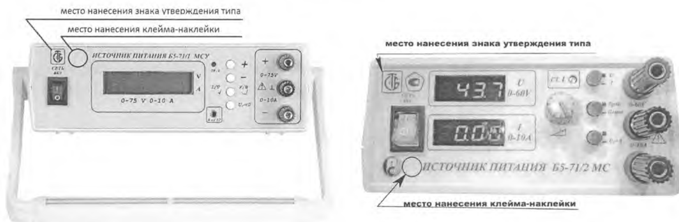
Рисунок А.1 – Место нанесения знака утверждения типа и знака поверки (в виде клейма-наклейки)
