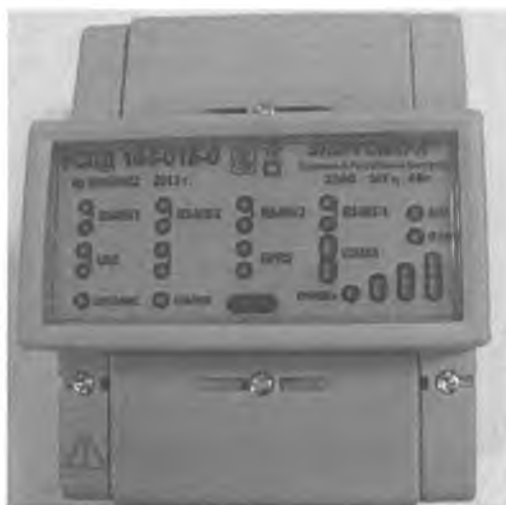
Рисунок 1 – Внешний вид устройств сбора и передачи данных УСПД 164-01Б-0 и УСПД 164-01Б-1
