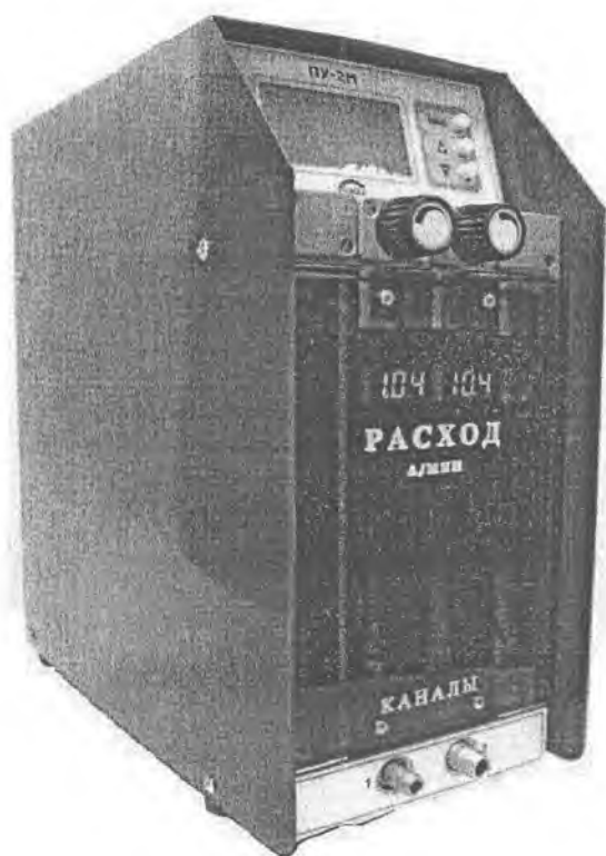
Рис. 5 Аспиратор ПУ-2М, ПУ-2М исп.1
