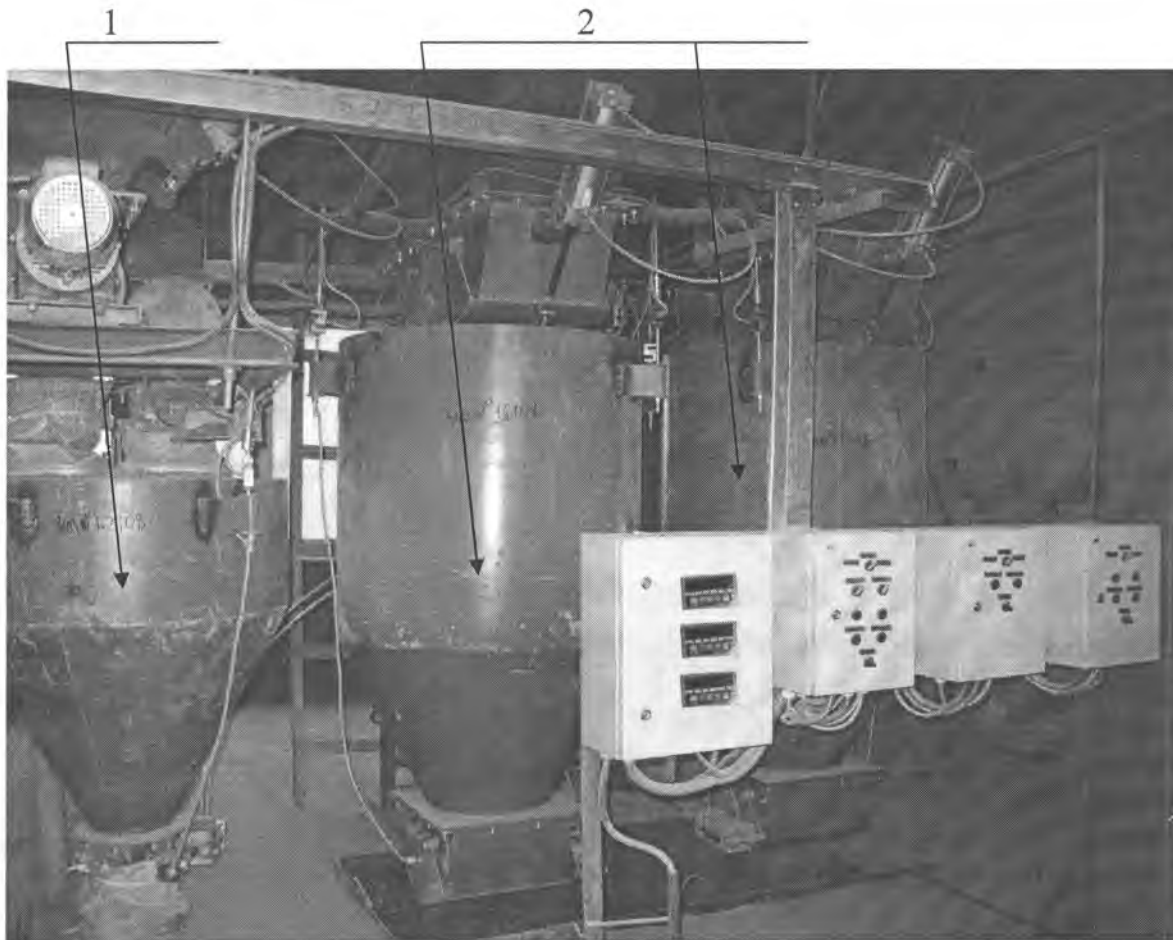
Рисунок 2. Дозатор мелкодисперсных материалов (1) и дозаторы крупнодисперсных материалов (2)
