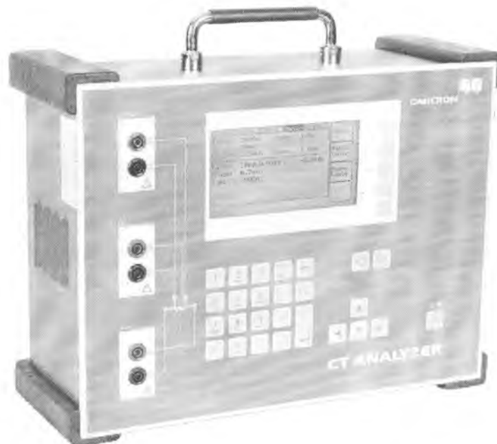
Рисунок 1. Общий вид анализатора трансформаторов тока CT Analyzer.
