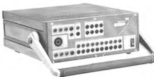
Рисунок 2. Общий вид комплекса измерительного для испытаний в цепях четырехфазного напряжения / шестифазного тока СМС 353.
