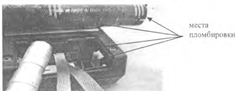
Рисунок 2 - Схема пломбировки твердомера.
