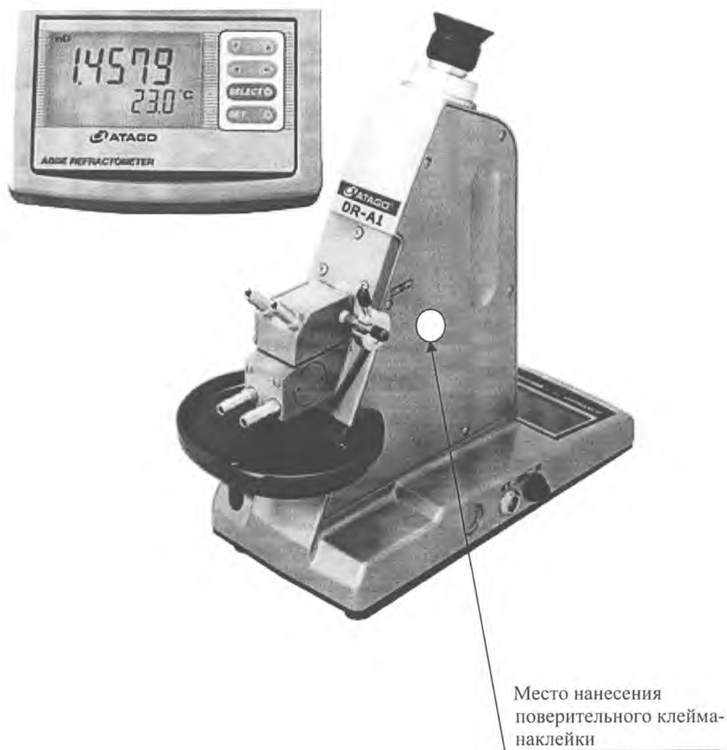
Рисунок А.1 – Место нанесения поверительного клейма-наклейки
