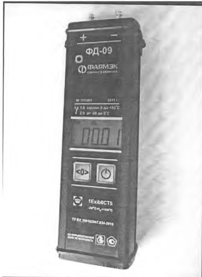
Рисунок 1 Внешний вид измерителя давления газа ФД-09
