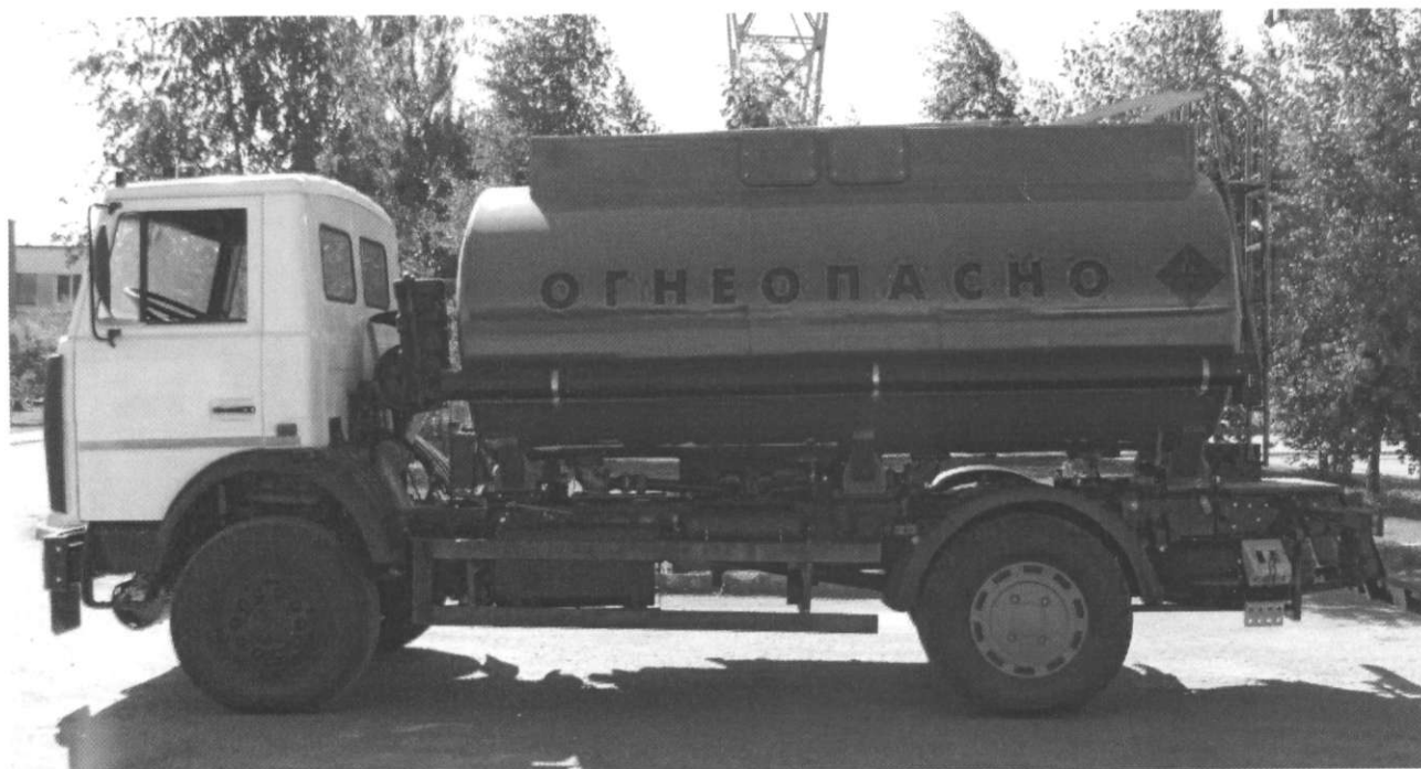
Рисунок 2 – Общий вид автотопливозаправщика АТЗ-2-11-5337
