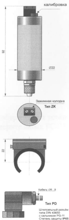
Рисунок 4 - Внешний вид, габаритные и установочные размеры преобразователей давления измерительных РС-28G
