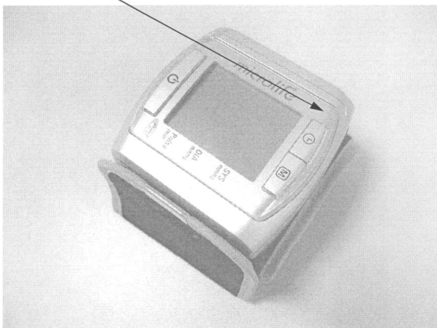
Рисунок А.19 Внешний вид измерителя ВР W90 и место нанесения знака поверки
