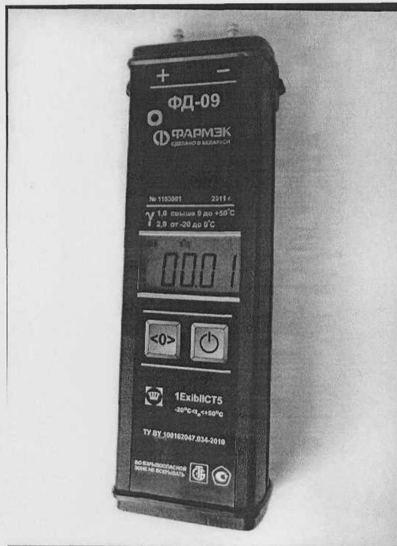
Рисунок 1 Внешний вид измерителя давления газа ФД-09
