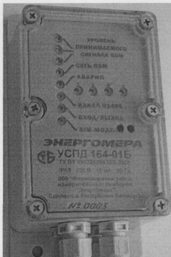
Рисунок 3 – Внешний вид Устройства сбора и передачи данных УСПД 164-01Б-2, и УСПД 164-01Б-3
