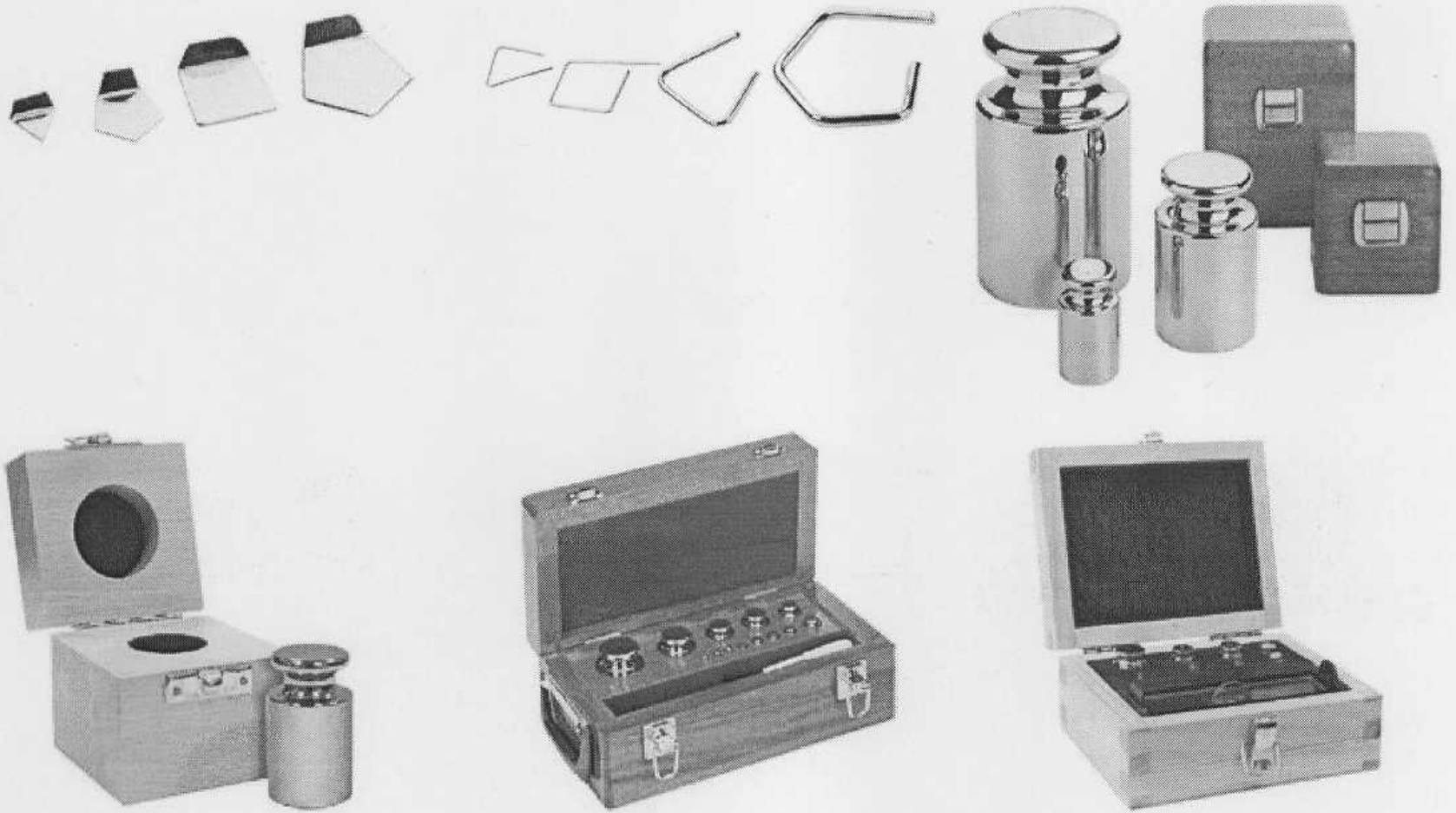
Рисунок 1 Внешний вид гирь классов точности E 2 , F 1 , F 2 , M 1
