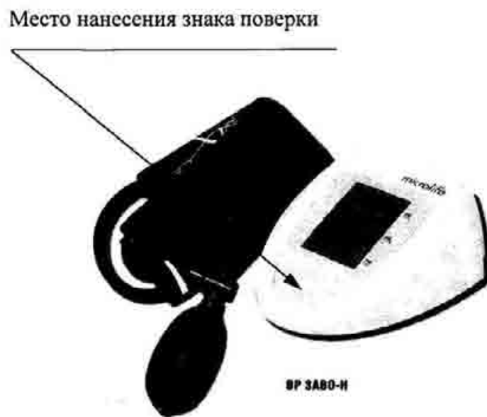
Рисунок А.4 Внешний вид измерителя BP 3AB0-H и место нанесения знака поверки
