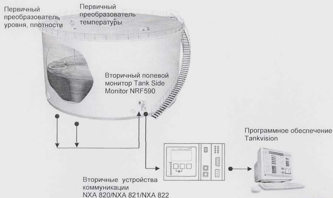
Рисунок 1 – Внешний вид систем информационно-измерительных Tankvision.
