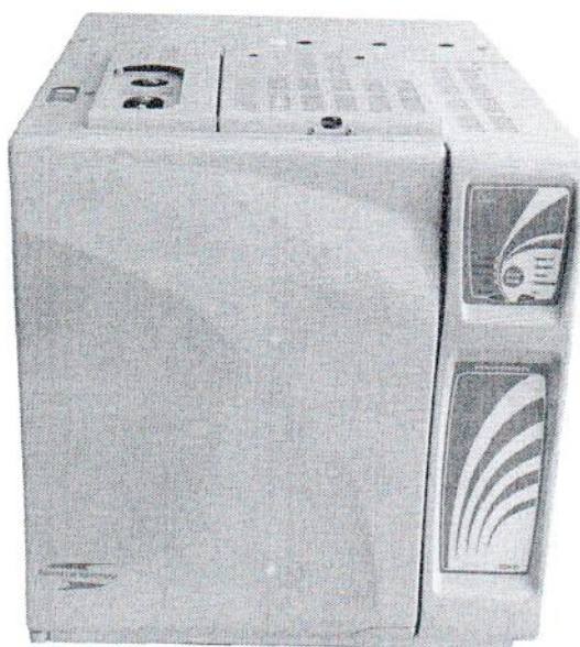
Рисунок 1 Общий вид хроматографа «Хроматэк-Кристалл 9000»
