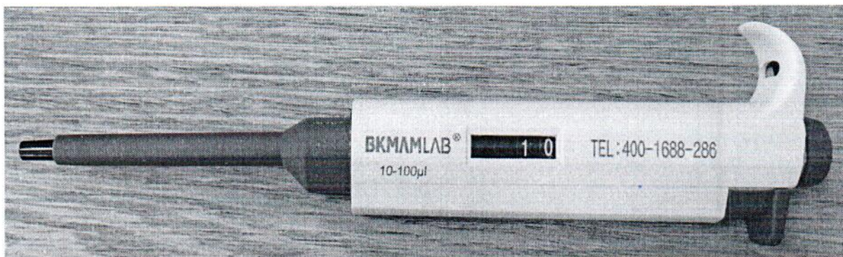
Рисунок 1.1 – Фотография общего вида одноканальных дозаторов с варьируемым объемом дозирования (изображение носит иллюстративный характер)
