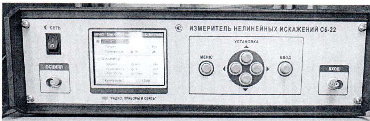
Рисунок 1.1 – Фотография общего вида измерителя нелинейных искажений С6-22 № 069
