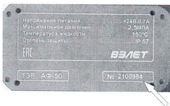
Рисунок 3 – Обозначение места нанесения заводского номера
