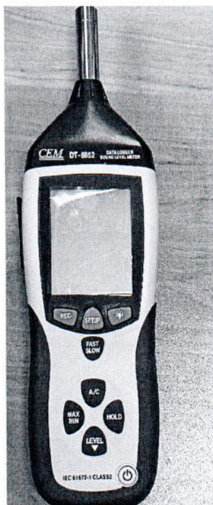
Рисунок 1.1 – Фотография общего вида измерителя уровня звука DT- 8852 № 230737288
