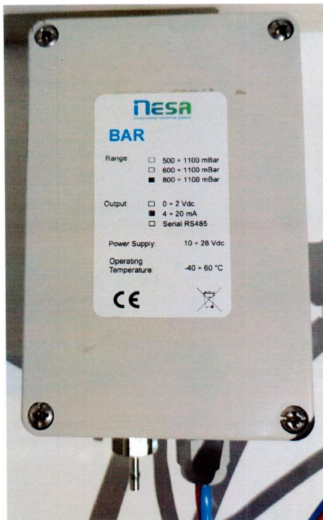
Рисунок 1.1 – Фотография общего вида датчика атмосферного давления BAR-B № 1013249
