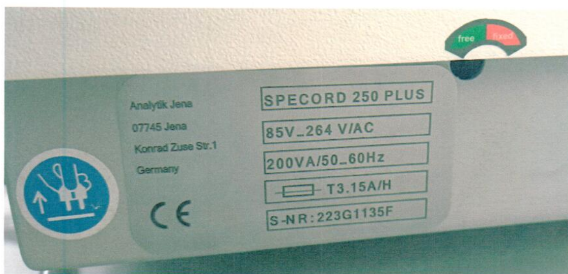
Рисунок 1.2 – Фотография маркировки спектрофотометра SPECORD 250 PLUS (изображение носит иллюстративный характер)
