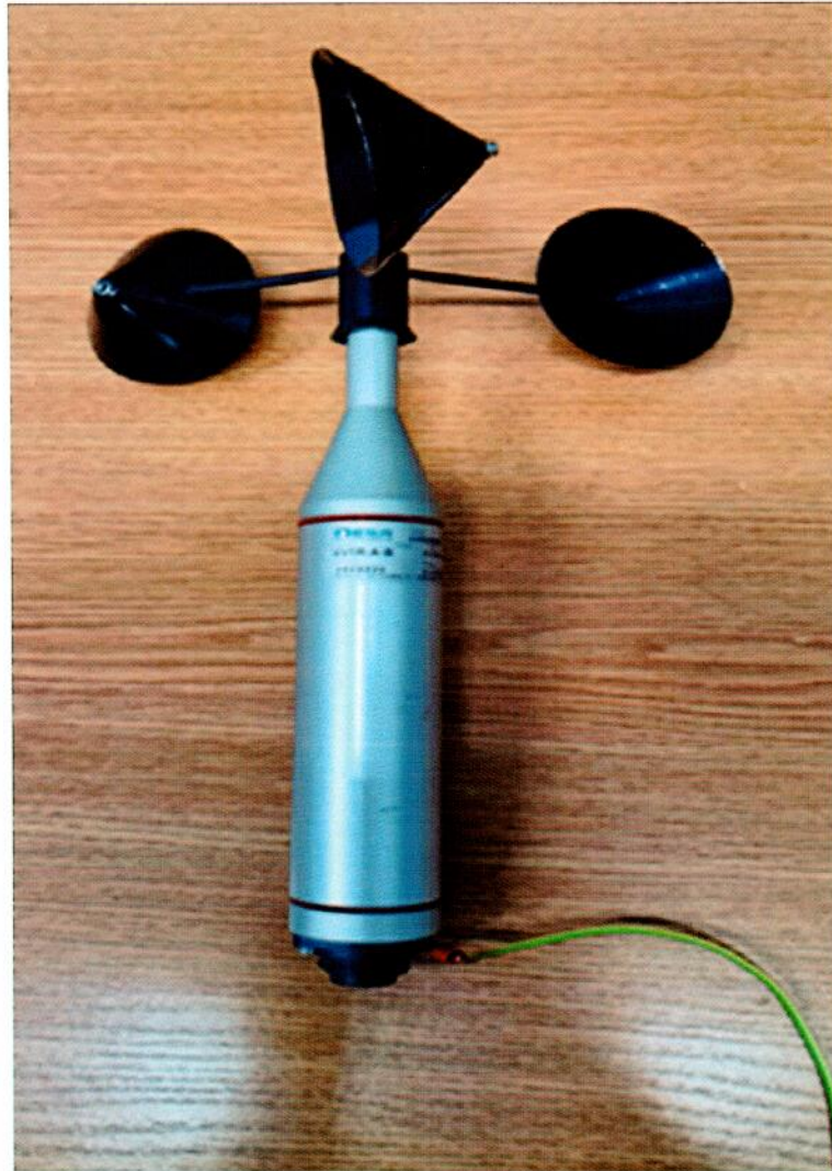
Рисунок 1.1 – Фотография общего вида датчика скорости ветра VV1R № 1013221
