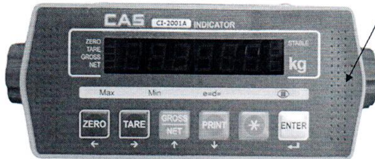
Рисунок 2.1 – Фотография с указанием места нанесения знака поверки (наклейки) на лицевую сторону индикатора весового CAS CI- 2001A
