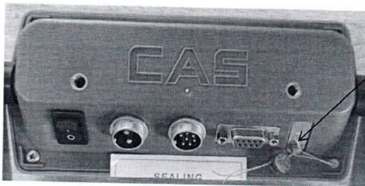
Рисунок 3.1 – Фотография с указанием места пломбировки от несанкционированного доступа в виде давления на пломбу на тыльной стороне индикатора весового CAS CI-2001A
