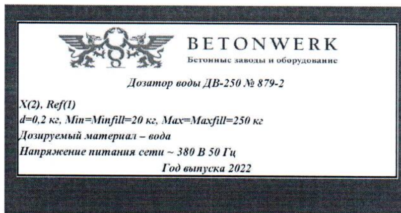
Рисунок 1.2 – Маркировка дозатора воды ДВ-250 № 879-2
