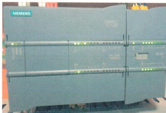
Рисунок 1.3 – Фотография контроллера программируемого SIMATIC S7-1200 с модулем ввода аналоговых сигналов 6ES7231-4HF32-0XB0
