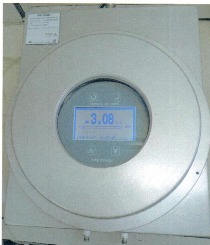
Рисунок 1.1 – Фотография общего вида газоанализатора МЕТРАН АГ 300В № 303322018
