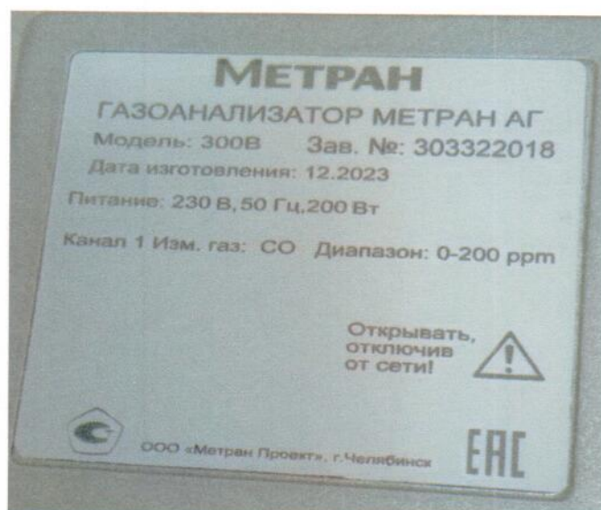
Рисунок 1.2 – Фотография маркировки газоанализатора МЕТРАН АГ 300В № 303322018
