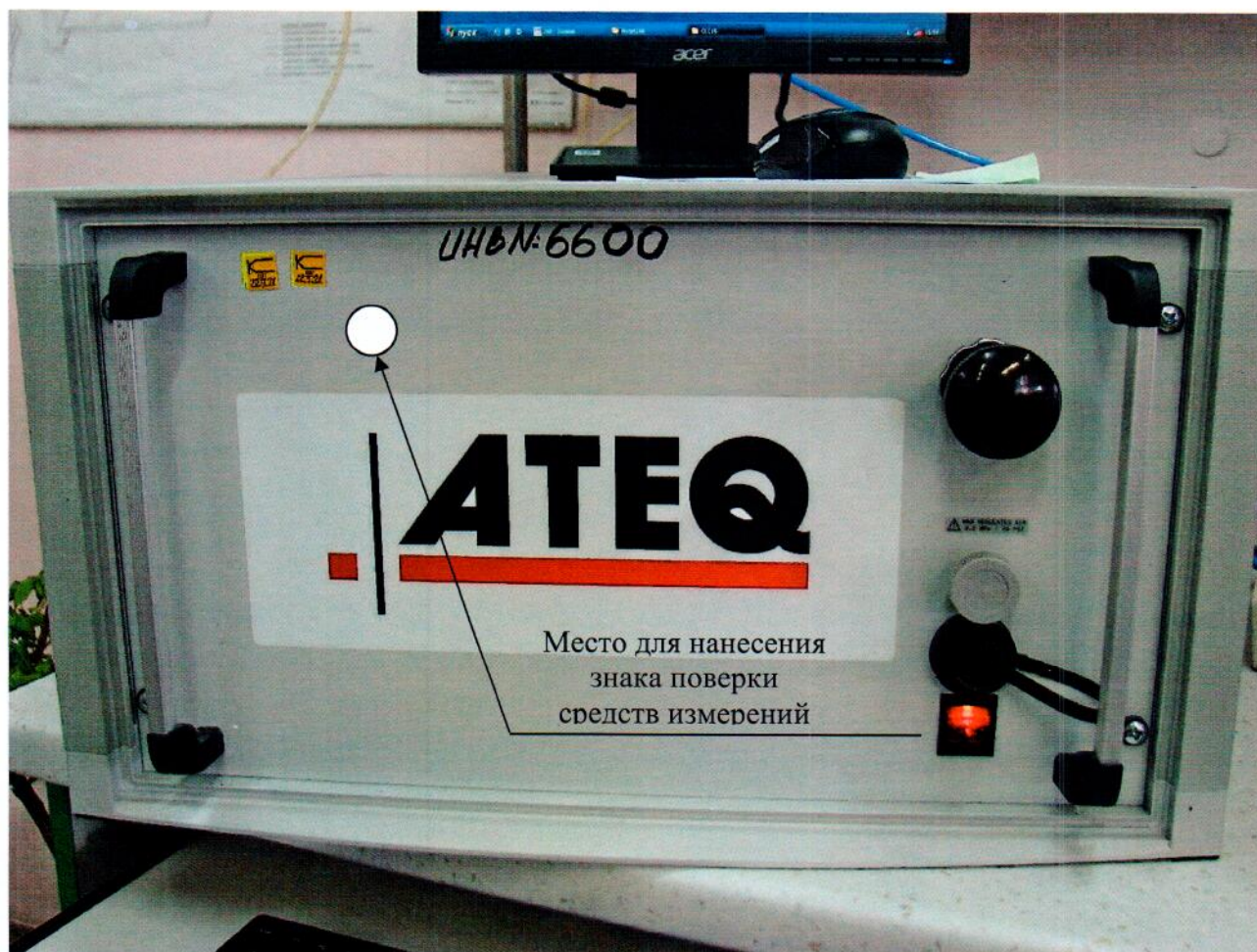
Рисунок 2.1 – Схема (рисунок) с указанием места для нанесения знака поверки средств измерений
