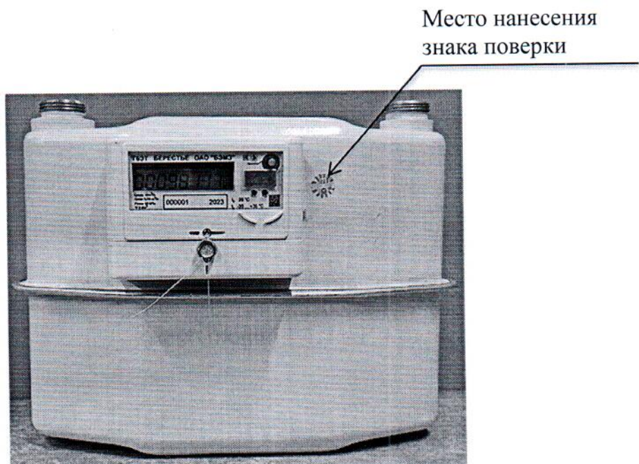
Рисунок 2.2 – Схема с указанием места нанесения знака поверки счетчиков газа типоразмера 4, 6 «Берестье», исполнений Г4Э, Г4ЭТ, Г6Э, Г6ЭТ
