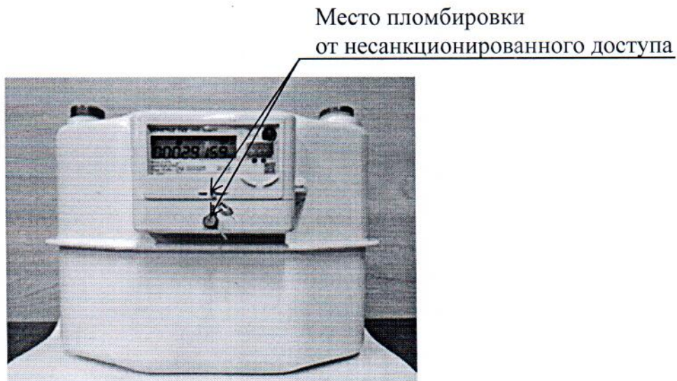
Рисунок 3.2 – Схема пломбировки от несанкционированного доступа счетчиков газа типоразмера 4, 6 «Берестье», исполнений Г4Э; Г4ЭТ; Г6Э; Г6ЭТ
