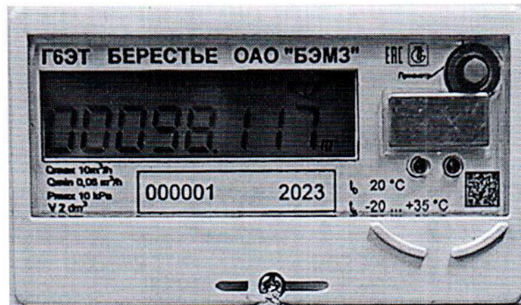
Рисунок 1.3 Маркировка счётчиков газа типоразмера 4, 6 «Берестье» с электронным отсчетным устройством
