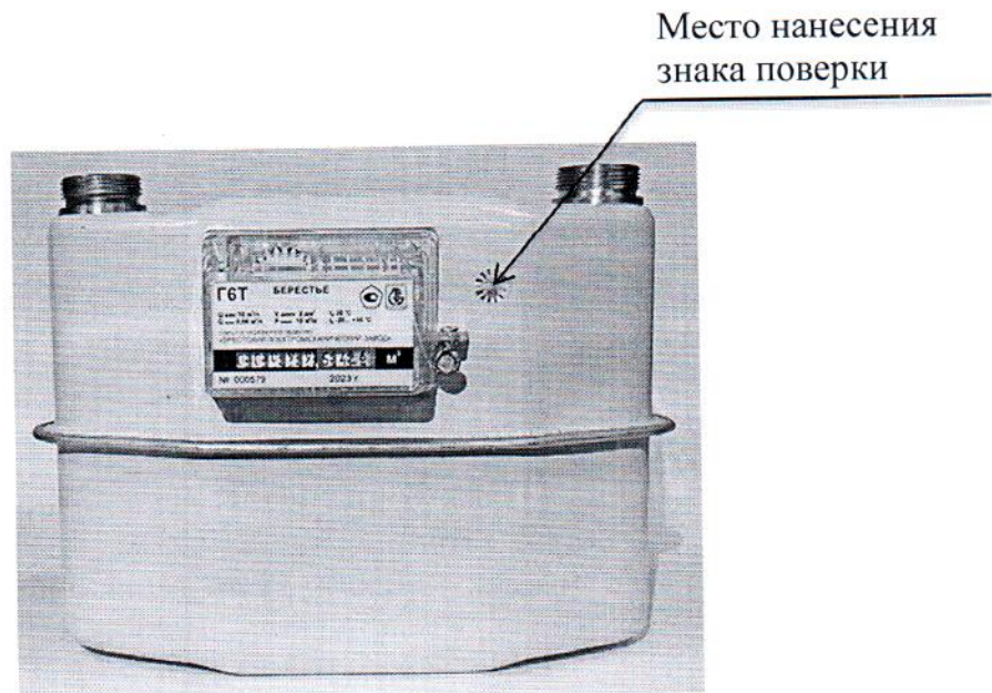
Рисунок 2.1 – Схема с указанием места нанесения знака поверки счетчиков газа типоразмера 4, 6 «Берестье», исполнений Г4, Г4Т, Г6, Г6Т
