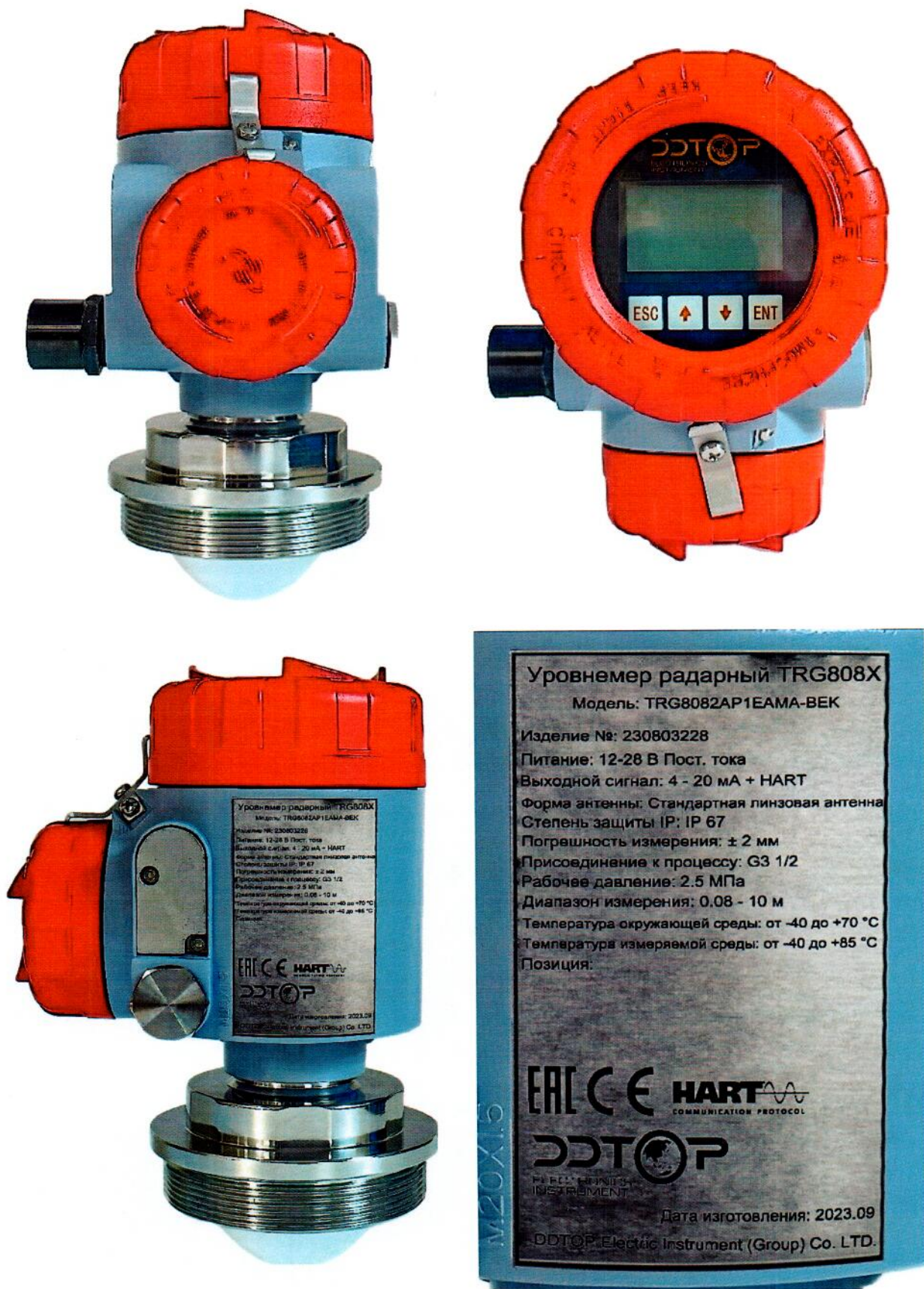
Рисунок 1.2 – Фотографии внешнего вида и маркировки уровнемера, представленного на испытания в целях утверждения типа средств измерений
