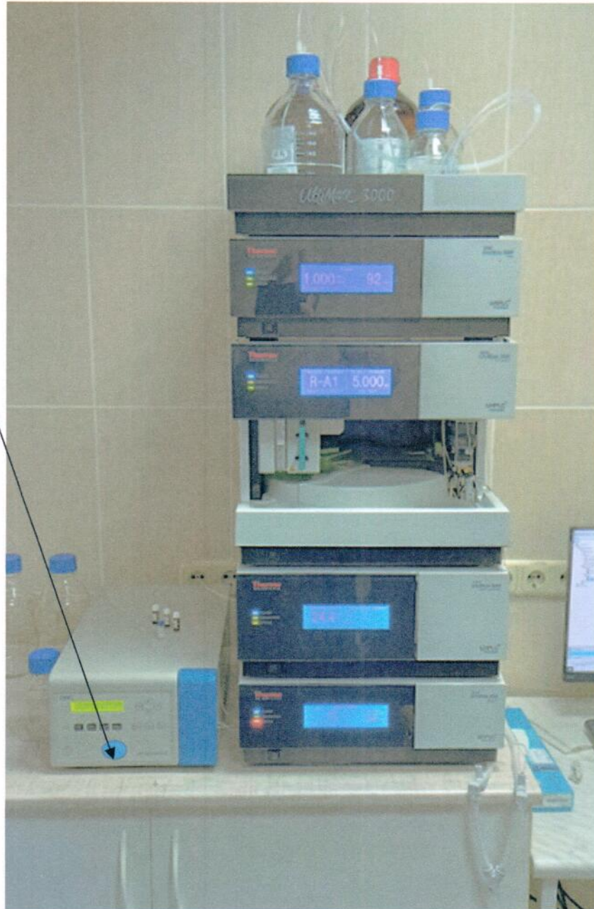
Рисунок 2.1 – Схема с указанием места нанесения знака поверки (клеймо-наклейки) для хроматографа жидкостного UltiMate 3000
