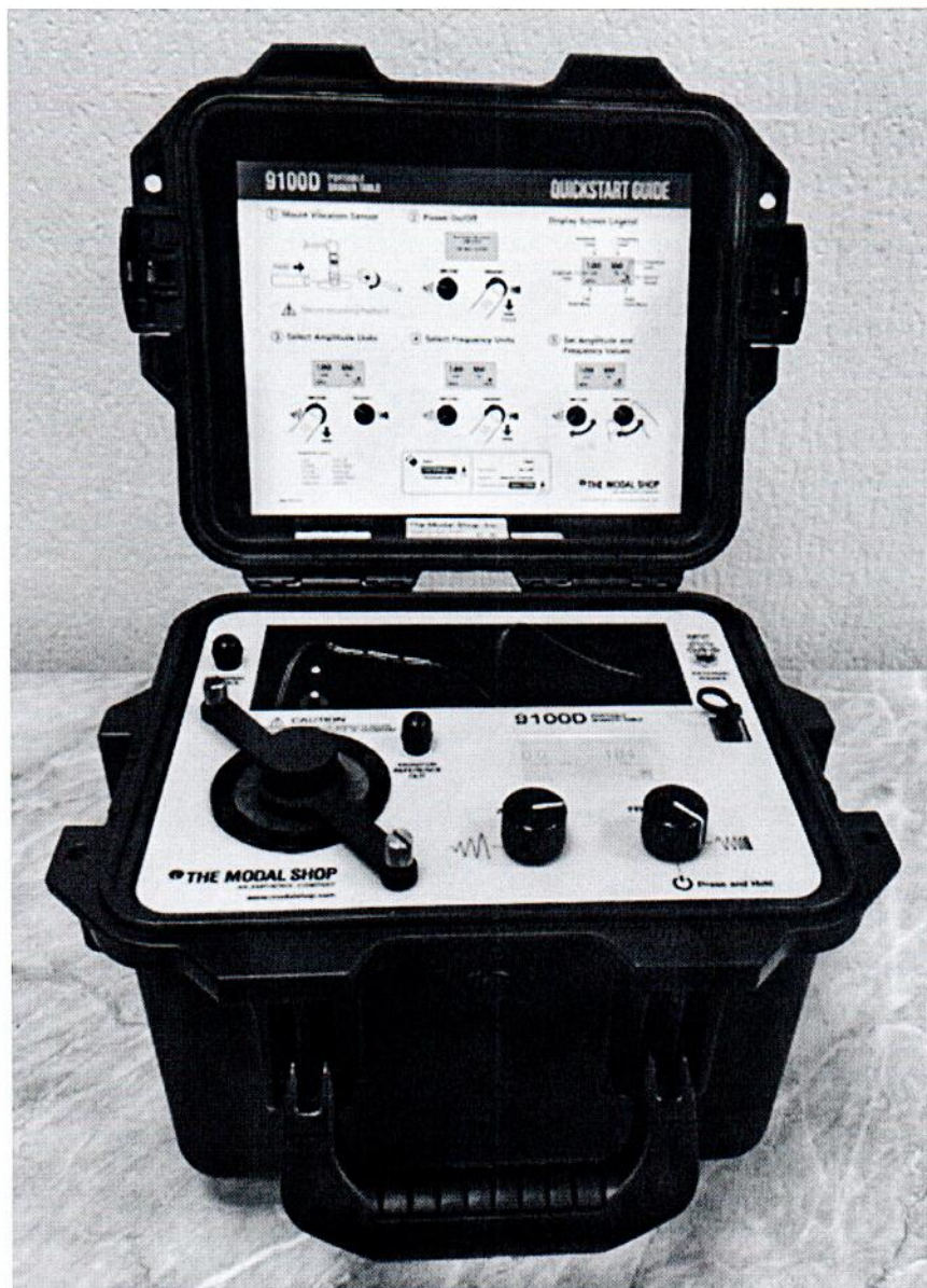
Рисунок 1.1 – Фотографии общего вида стенда калибровки датчиков вибрации портативного 9100D № 2463
