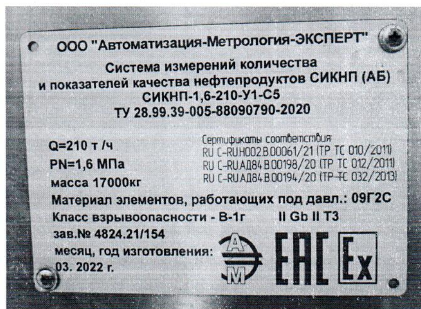
Рисунок 1.2 – Фотографии маркировочной таблицы системы измерений количества и показателей качества нефтепродуктов, отгруженных ОАО «Нафтан» на филиал «Новополоцк» ОАО «Гомельтранснефть Дружба» № 4824.21/154
