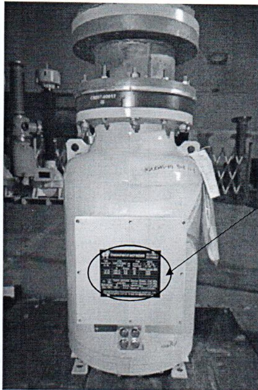
Рисунок 1.1 – Фотография общего вида трансформаторов напряжения индуктивных измерительных JDQXF-145
