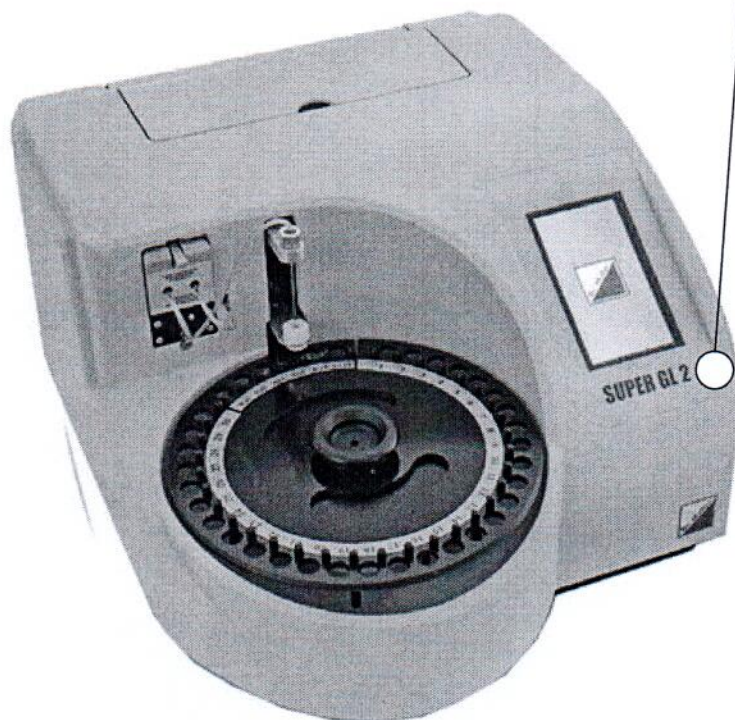
Рисунок 2 – Схема с указанием мест для нанесения знака поверки анализаторов глюкозы и лактата SUPER GL
