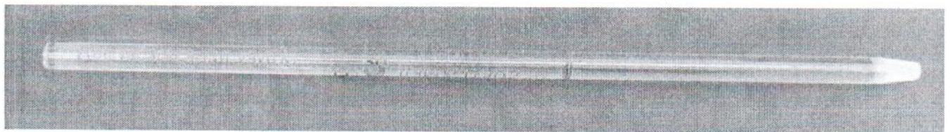
Рисунок 1 – Общий вид пипетки прямой стеклянной (типа Сали)
